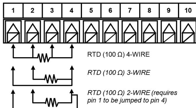
**Figure 3. RTD Wiring Diagram**
