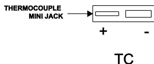
**Figure 6. Thermocouple Input.**
